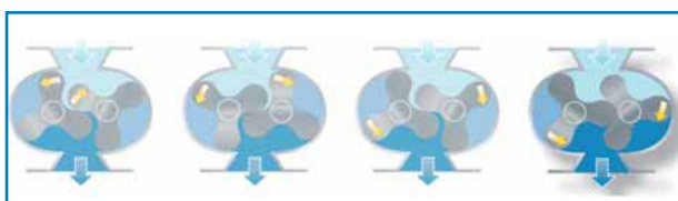
Figura 1.- Principio de funcionamiento de una soplante de lóbulos tipo "Roots"trigo.
