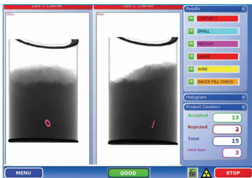
Figura 1.- Imagen por rayos X de una lata de leche en polvo contaminada.
